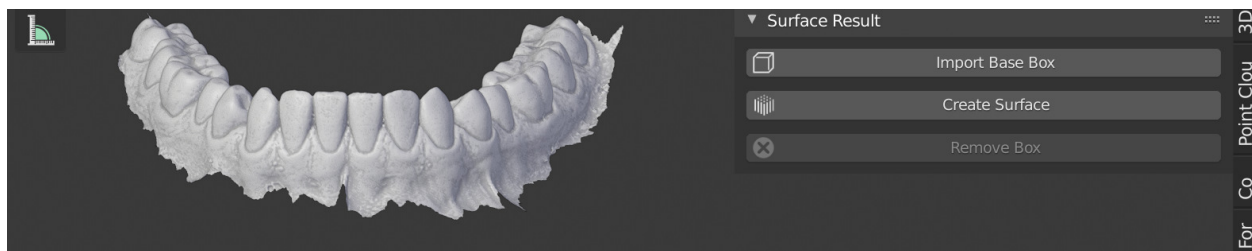
Figura5: Seção da criação da superfície anti-retenção no OthersOnBlender.
