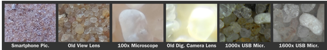
Figura19: Comparação entre todos os microscópios ao observar grãos de areia.
