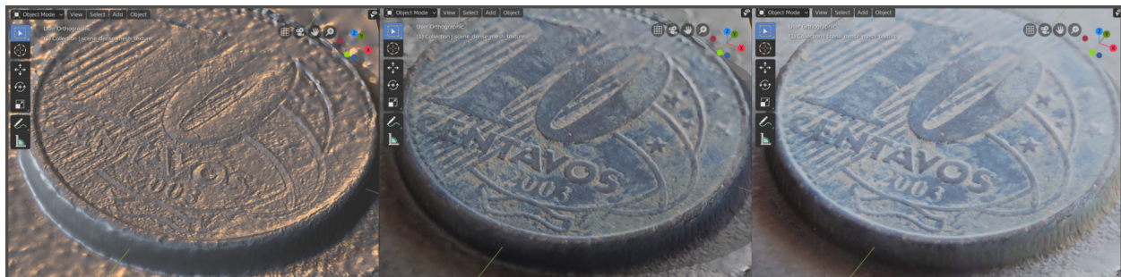
Figura3: Moeda digitalizada em 3D por fotografias (fotogrametria). Malha sem textura, sólido + textura e apenas textura.
