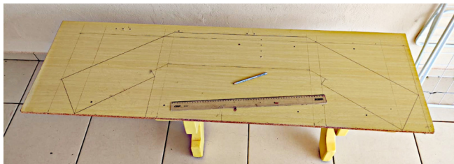
Figura11: Traçado finalizado sobre a chapa de MDF
