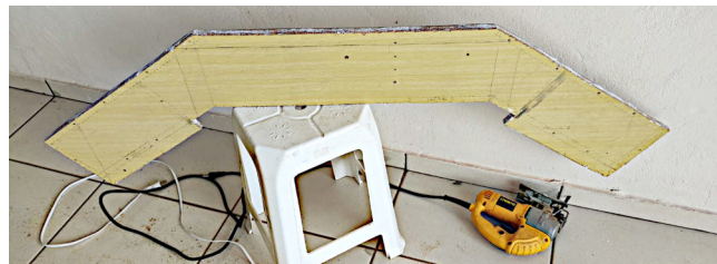
Figura13: Chapa cortada com as bordas preparadas com cola escolar
