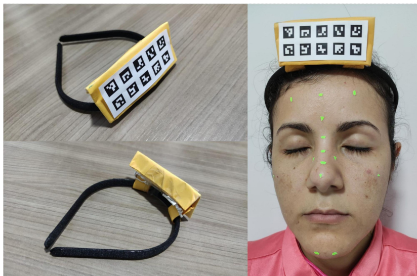
Figura4: Tiara com os marcadores ArUco alinhados com a parede e o piso (quando colocados na cabeça)
