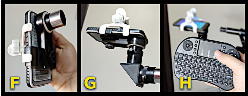
Figura3: Adaptação do *smartphone* ao telescópio
