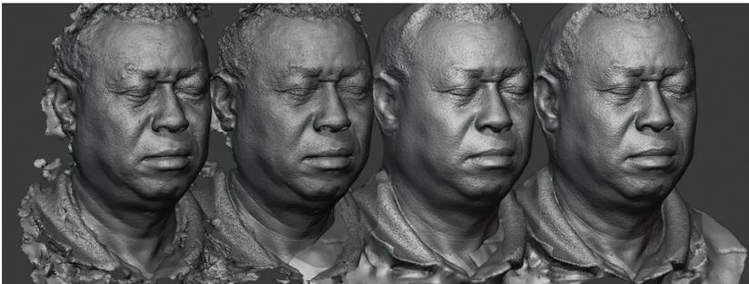
Figura6: SMVS+MVE default, SMVE+MVE detalhado, OpenMVG+OpenMVS default, OpenMVG+OpenMVS detalhado. Displacement ativo.
